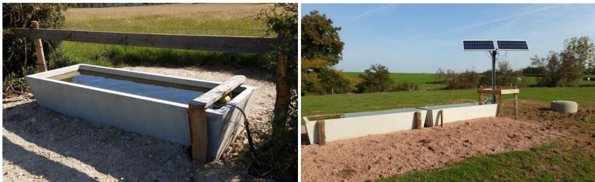
**Figure 12 : Exemples d'abreuvoirs avec pompe solaire**
