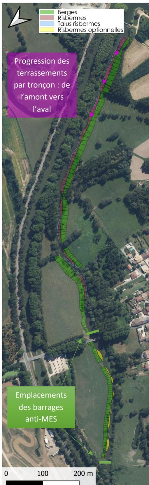
Concernant l'avancée des terrassements, elle sera réalisée progressivement d'amont vers l'aval avec un maintien en continu de barrages flottants anti-MES à l'aval. Deux secteurs sont prévus pour les barrages anti-MES. La première option se situe au droit du pont sur la RD1C qui marque la fin du secteur amont et qui est un endroit à privilégier pour une mise en place simplifiée. Le second site est à l'aval de la zone de terrassement.
