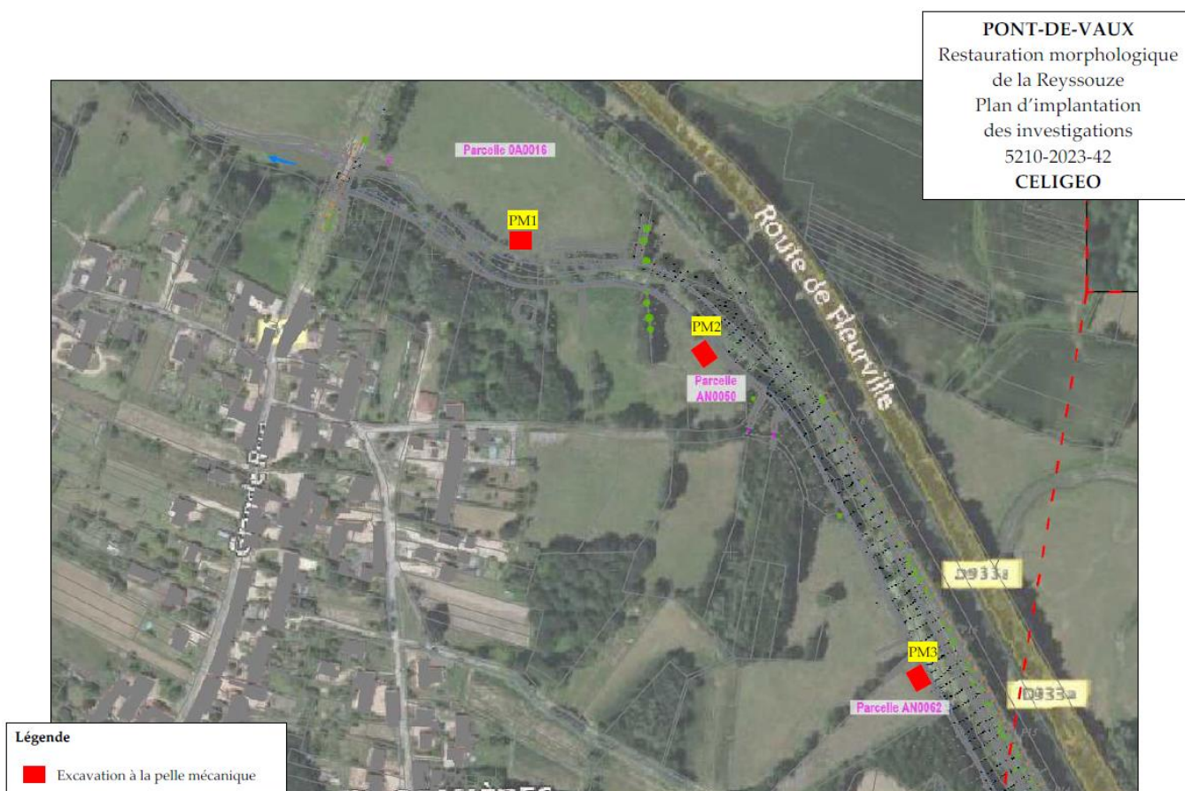
Figure 61 : Localisation des sondages géotechniques
