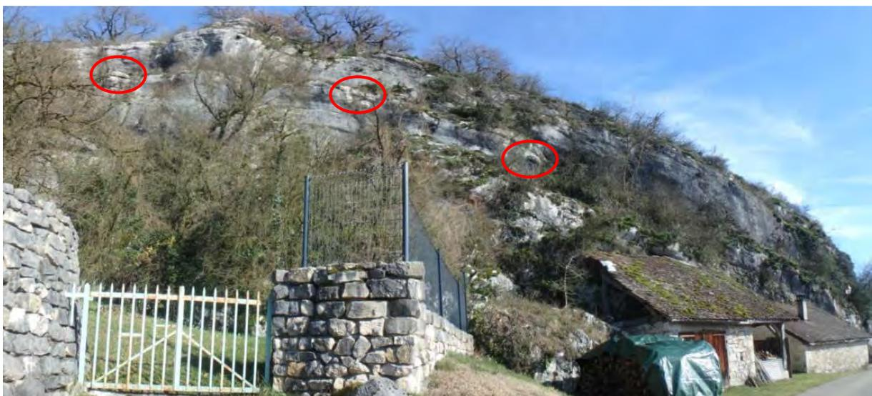
Figure 9 : Masses pouvant chuter
