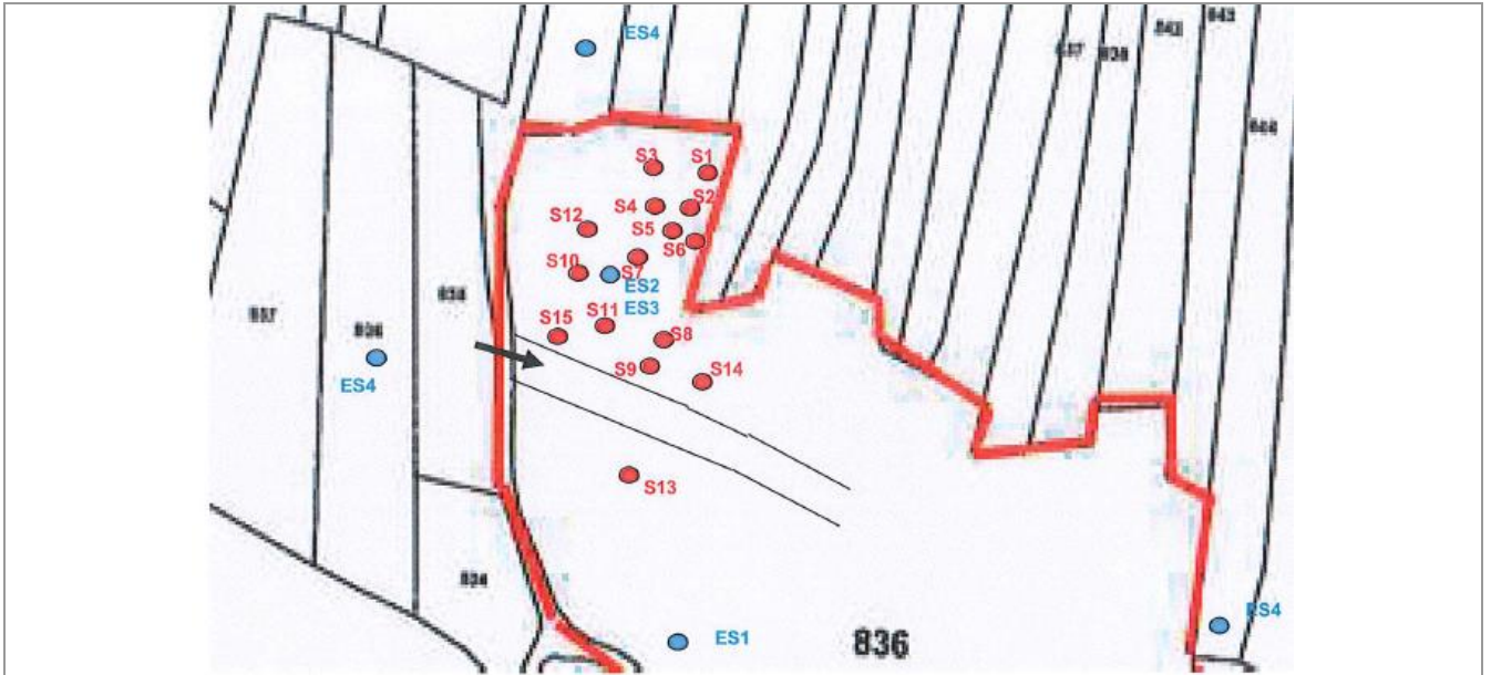
Figure 8: Plan de Localisation des sondages (S1 à S15 1ere campagne, points de couleur rouge , 2 nd e campagne, points de couleur bleue)
