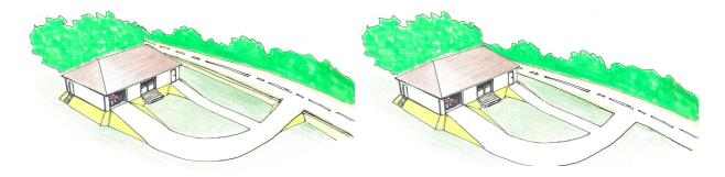
Par accès on entend la création d'une rampe en remblai de longueur la plus faible possible permettant de rejoindre le niveau du terrain naturel, comme le montrent les dessins de principe ci-dessus. Un seul accès piéton pour l'habitation et un seul accès pour le stationnement de véhicules.
