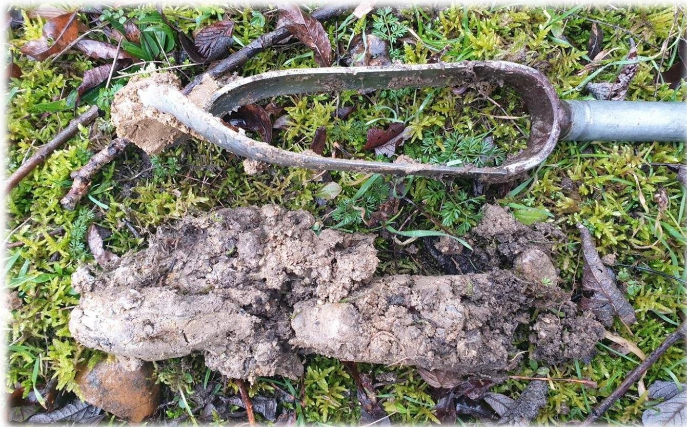
Figure 18. *Détail du sondage S04 de classe VI.d : détail de la présence de l'horizon réductique dès la surface*
