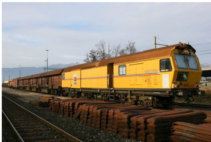
Train meuleur de rails (Scheuchzer S.A.)
