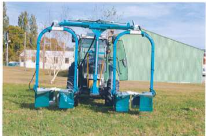
DHUGUES tunnel d'épamprage
