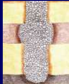
Colonnes ballastées mises en place par vibroflottation
