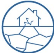
Retrait/gonflement des argiles
