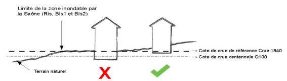
Dessin de principe, les sous-sols doivent être au-dessus de la cote de crue centennale de la Saône
