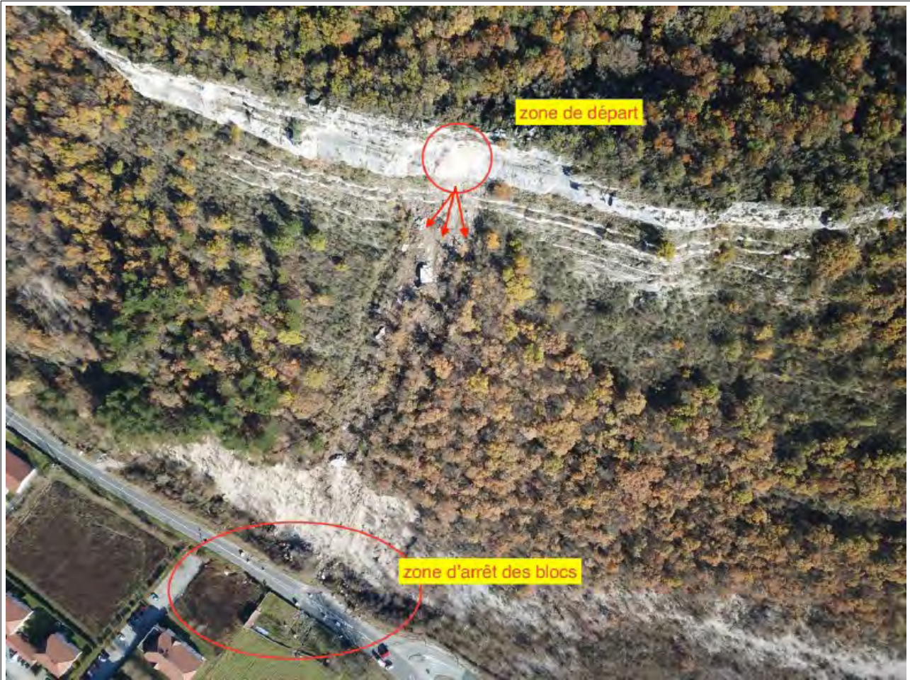
Rochers de La Craz: Localisation de la zone de départ et de la zone d'arrêt des blocs lors de l'évènement de 2017 (source : rapport SAGE 2017)
