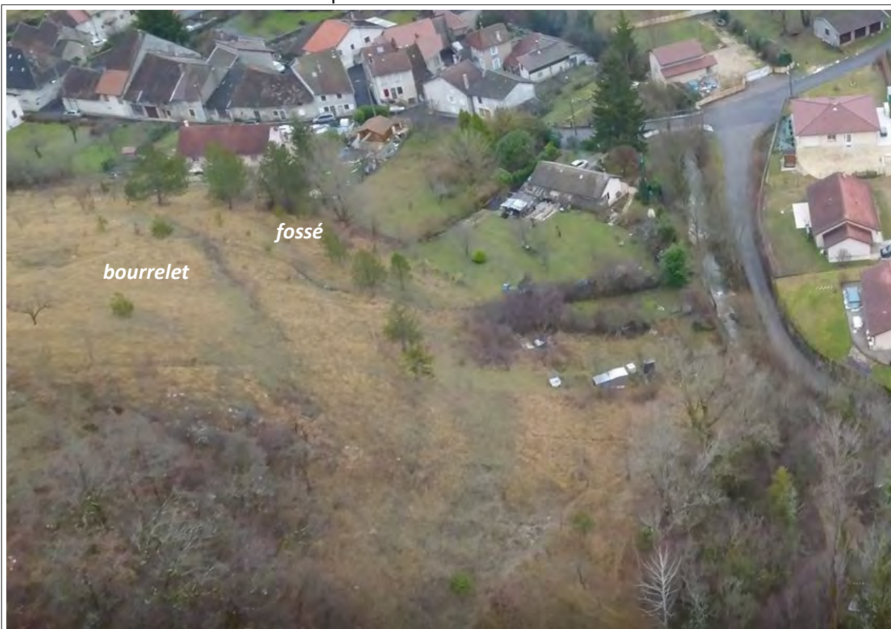
Les Tonnes: le bourrelet de colluvions argileuses et le fossé drainant la source
