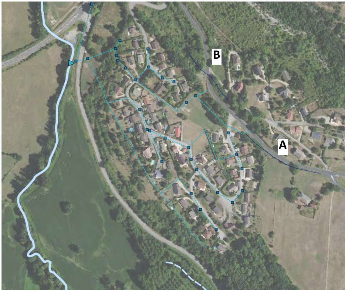
Réseau d'eaux pluviales du quartier du Murat
