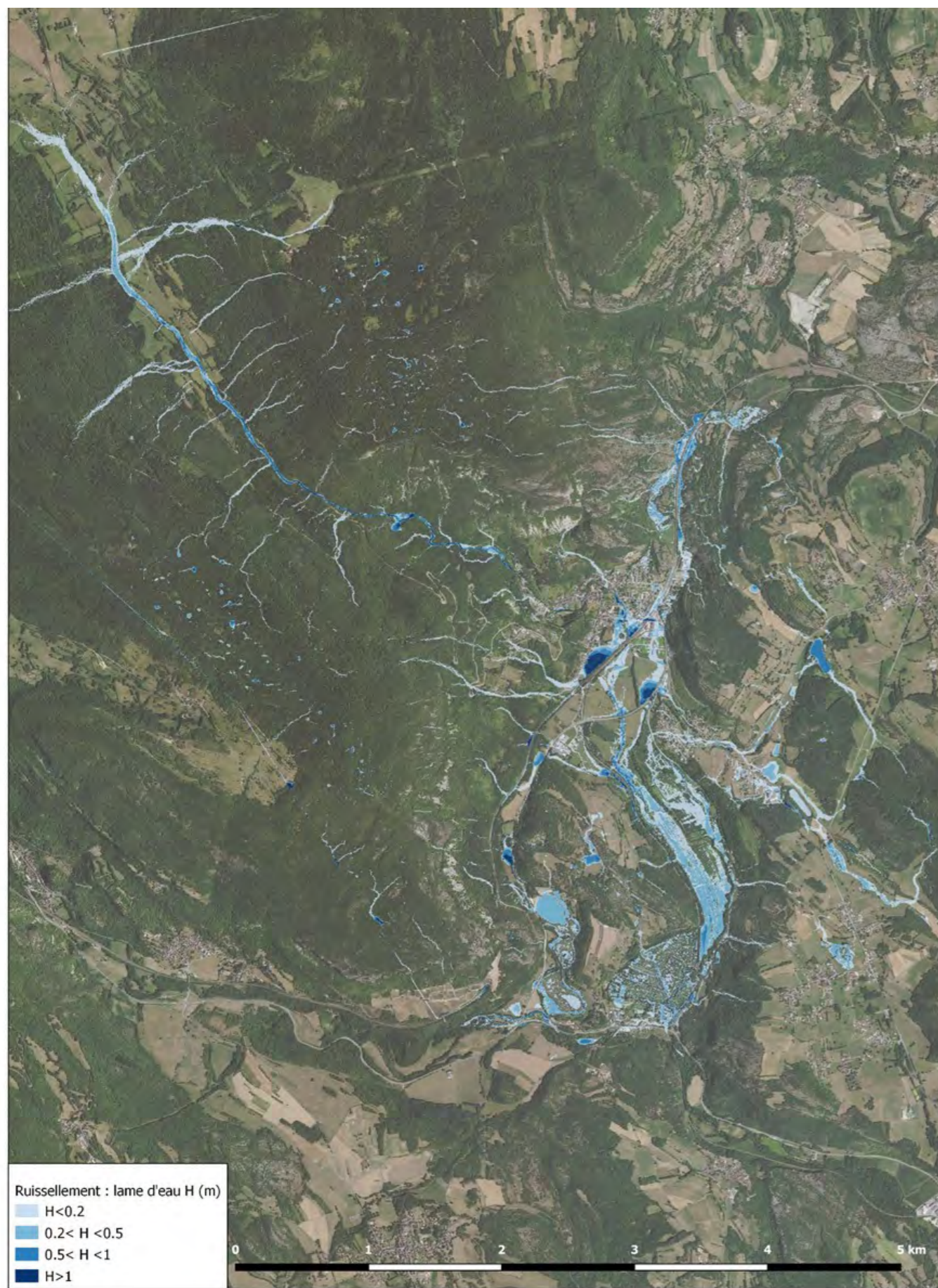
P100_10 - Lame d'eau ruissellée
