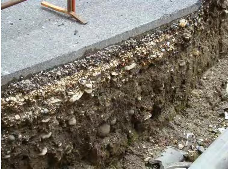
**Fig. 9 :** Affleurement d'alluvions anciennes du Riss, dans une tranchée rue de la Perte du Rhône [Source : IMS<sub>RN</sub>]
