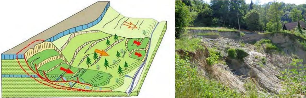
**Fig. 17 :** Schéma conceptuel d'un glissement de terrain et glissement rue Marthe Perrin à Bellegarde/V
