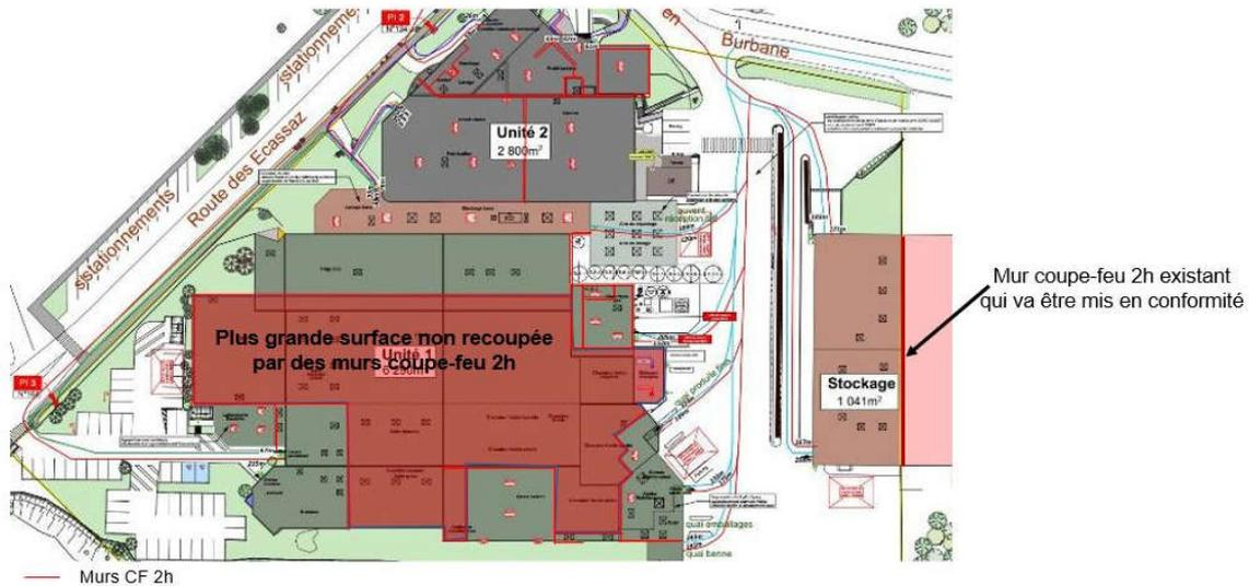
Au niveau du stockage emballages, un mur mitoyen coupe-feu 2 heures existe, il est prévu de le mettre en conformité (dépassement en toiture).
