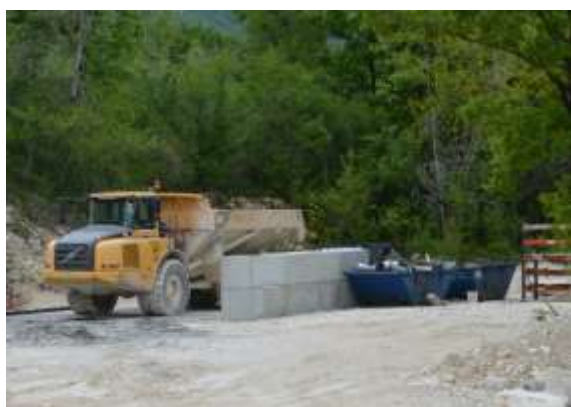
Tombereau sur l'aire étanche, bennes à déchets à proximité
