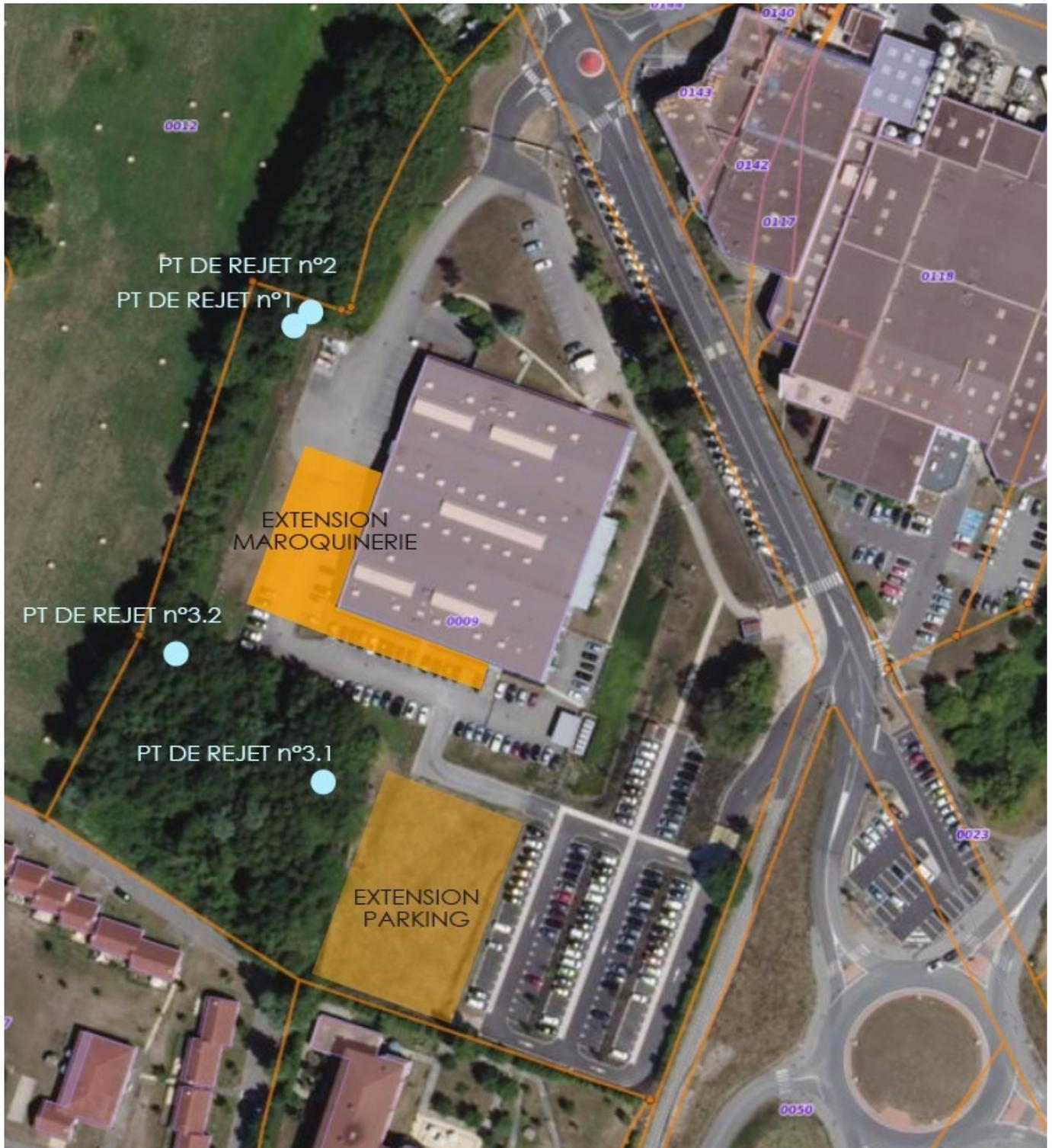
**ANNEXE 3 : Points de mesure de bruit en limite de propriété et en zone à émergence réglementée**
