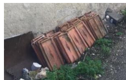
Tuiles mécaniques losangée, ardoises (toiture à la Mansart)
