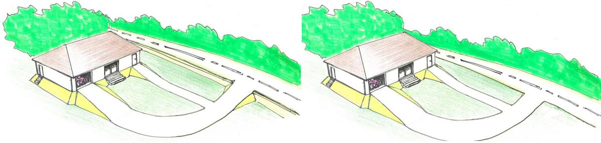
Par accès on entend la création d'une rampe en remblai de longueur la plus faible possible permettant de rejoindre le niveau du terrain naturel, comme le montrent les dessins de principe ci-dessus. Un seul accès piéton pour l'habitation et un seul accès pour le stationnement de véhicules.
