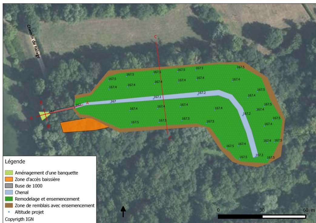
Figure 26 : Carte de localisation des aménagements (en rouge la localisation des schémas de coupe des ouvrages).
