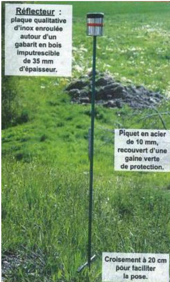
Photographie d'un dispositif anticollisions
