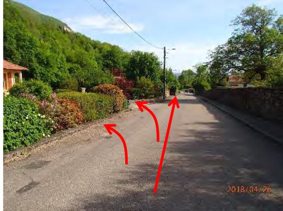
Figure 46 : Déversement vers les propriétés en rive gauche et débordements sur voirie
