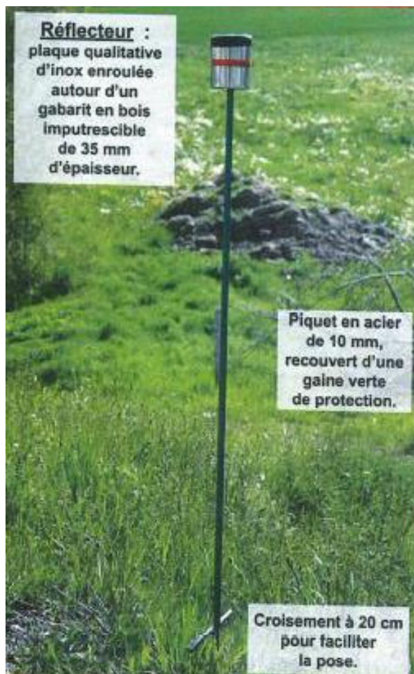
Photographie d'un dispositif anticollisions Source : Instinctivement nature
